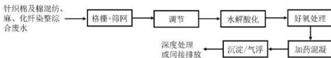
图 7-9 针织棉及棉混纺染整、麻染整以及化纤染整的综合废水常规处理工艺流程图
