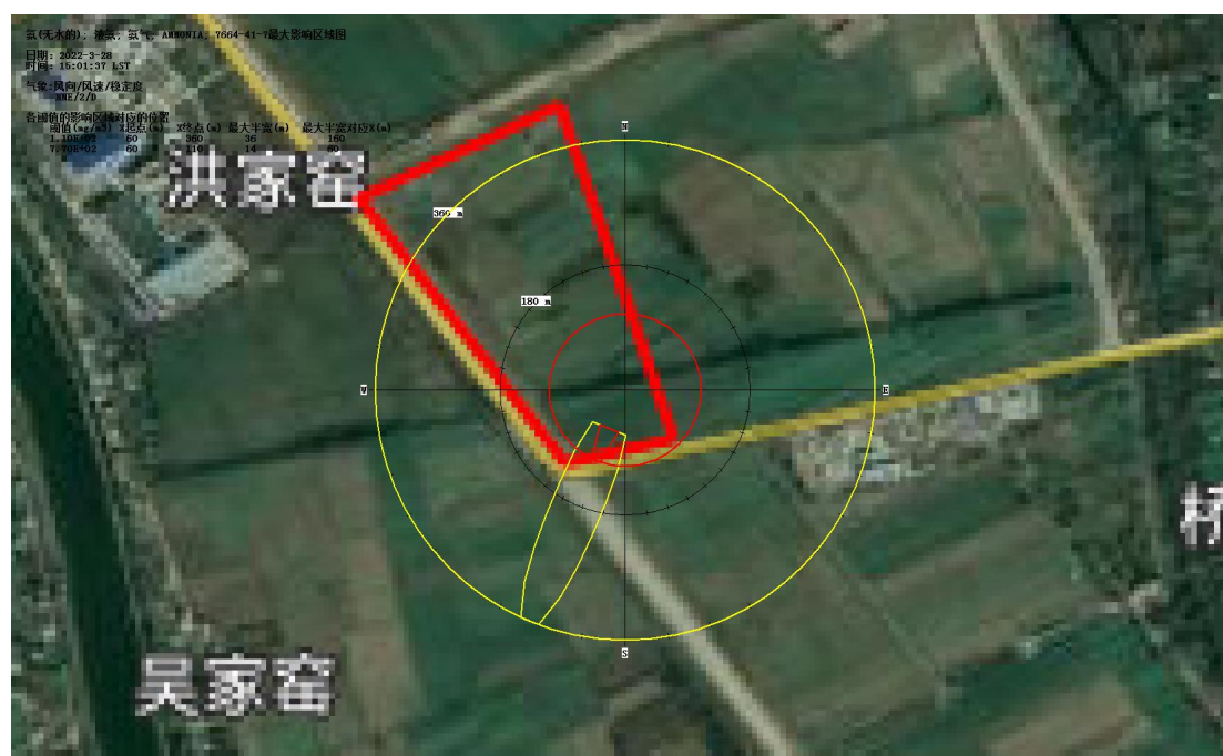
图 6-18 液氨超过阈值的廓线图
