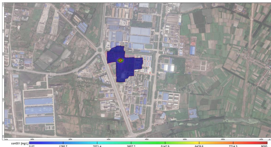
图 5-19 泄漏发生污染晕分布图（100 天）
